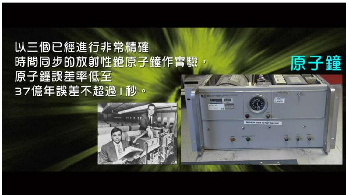
進行實驗時，他們將一個原子鐘放在實驗室內做相對「靜止」的樣本，作為參考，另外兩個分別放在兩架民航機上。而兩架載有原子鐘的民航機，一架向東飛行，一架向西飛行，都是環繞地球飛行
