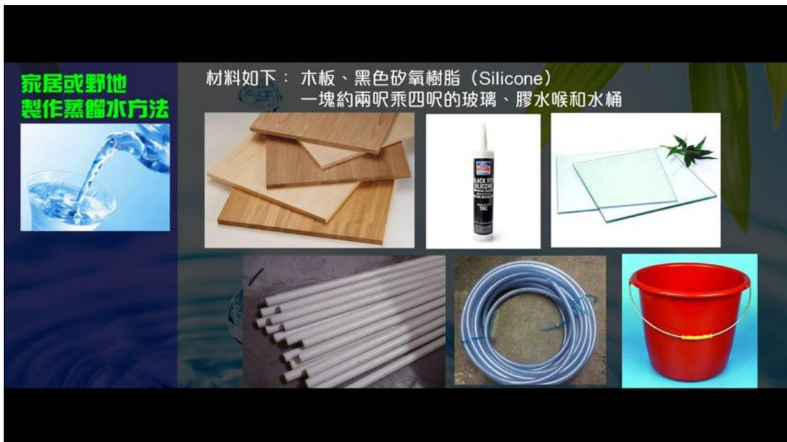
簡單來說，就是用木板製造一個玻璃頂木箱。玻璃頂是傾斜向一邊的，而木箱的內部則塗上一層黑色的矽氧樹脂，並在木箱玻璃的底部安裝一條可收集水的水管，這樣就可以把整個木箱放於陽光底下，把未經處理的水，例如：溪水、河水、甚至海水倒進木箱之內，陽光的熱力就會把污水蒸發並凝結在玻璃頂內。
